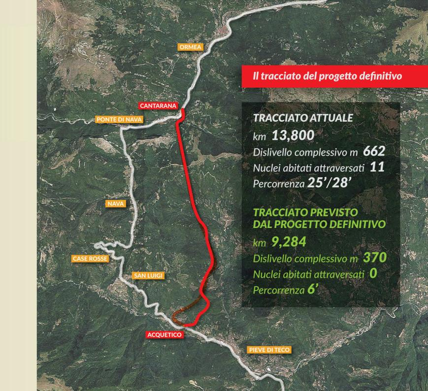
L'intervento si sviluppa per complessivi 9,284 Km, con sezione stradale C1 (D.M. 05/11/2001) di larghezza complessiva pari a 10,50 m:
